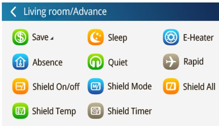
Функция быстрого охлаждения доступна только в режиме охлаждения, функция быстрого обогрева доступна только в режиме обогрева.
